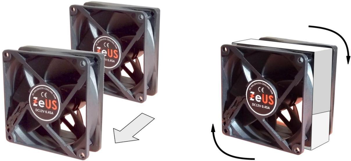
Ivice po kojima se ventilatori dodiruju čvrsto obmotajte izolir-trakom. Napravite tri puna kruga.
